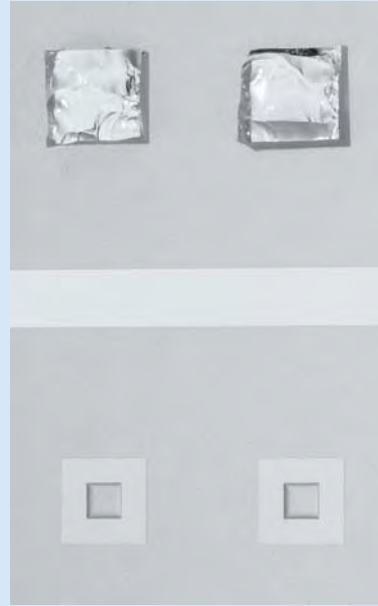
H150-10 Teilmattierung mit (Fläche anschliffert, Quadrate Tiefen- strahlung/Linien klar) mit Glasbrocken
