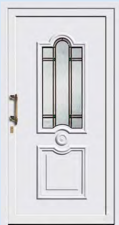
Kunststoff Modell 20423 (PG30) Aluminium Modell 40423 (PG33) Sonderausstattung: Kassette und Rosette Glas: Bleiverglasung G 04 Griff: HA3002 Messing brüniert PZ-Rosette: HA7316 Messing brüniert
